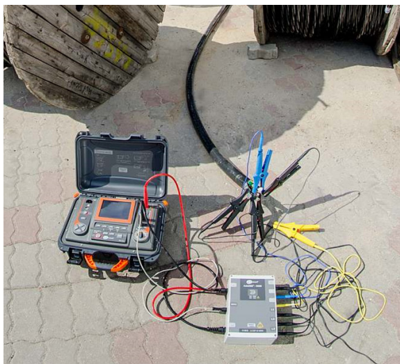
Obr. 2 Meranie izolačných odporov na 5-žilovom kábli pomocou adaptéra AutoISO-5000
