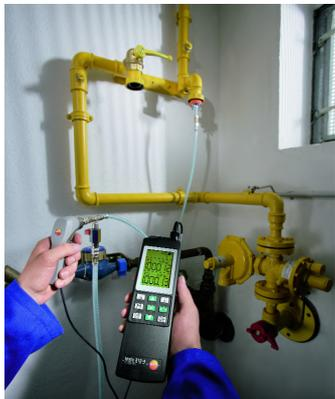
Zkouška pevnosti až do zkušebního tlaku 15 bar
