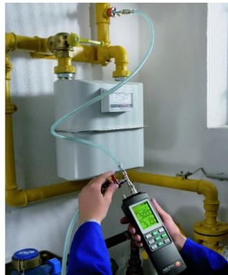
Zkouška provozuschopnosti podle ČSN EN 1775
