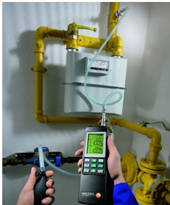
Zkouška těsnosti podle ČSN EN 1775
