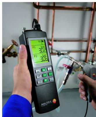
Zkouška tlaku na vodovodních a odpadních potrubích
