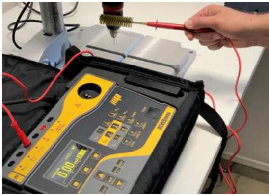
P 3070 – sonda pro snímání dotykového proudu z rotujících částí spotřebičů
