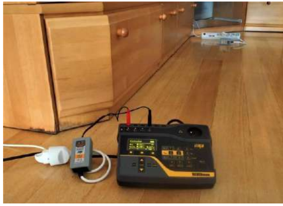
P 8080 - Adaptér pro testování odporu vodičů nepřístupně uložených prodlužovacích přívodů
