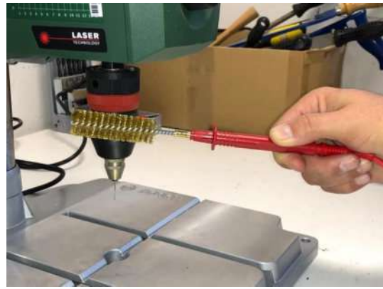
P 3070 – sonda pro snímání dotykového proudu z rotujících částí spotřebičů
