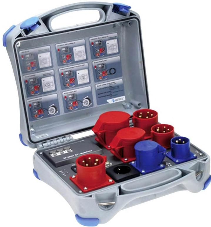
Multifunkčný adaptér A 1322 je určený pre pravidelné testovanie na trojfázových zariadeniach a strojoch, ako aj pre vyhľadávanie zdrojov porúch. Je vybavený unikátnymi funkciemi, napr. aktívny test zapojenia, test unikajúceho prúdu, test trojfázových prúdových chráničov (RCD), ktorými tento adaptér rozširuje možnosti obvyklého testovania.
