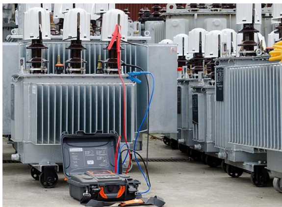
Obr. 5 Meranie odporu vinutia na VN transformátore s testerom MIC-10K1
